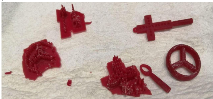
5. Удаление поддержек: я удаляю их руками, так как мелкая точка контакта легко отламывается, создавая "пенек". Некоторые труднодоступные поддержки убираю скальпелем. Пеньки потом убираем наждачкой или сатином.
