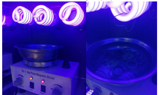
6. Вываривание с высвечиванием: Модели вывариваются в воде с температурой 80-85 градусов, 2 часа. В конце операции модель должна "побледнеть". Вываривание происходит совместно с засветкой под ультрафиолетом.
